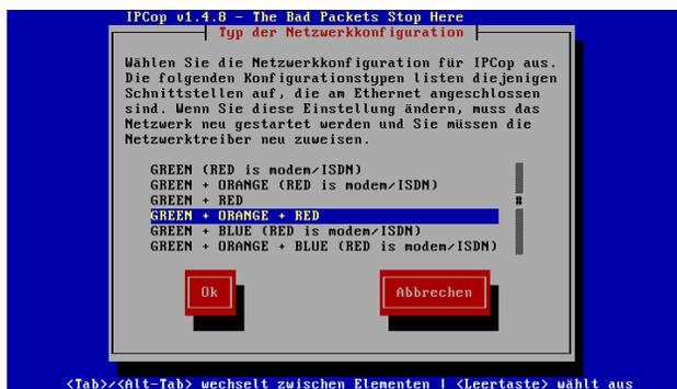
Abbildung 14.15: IPCop weist den Firewall-Zonen Farben zu. Wählen Sie die für Sie richtige Farbkombination aus.
