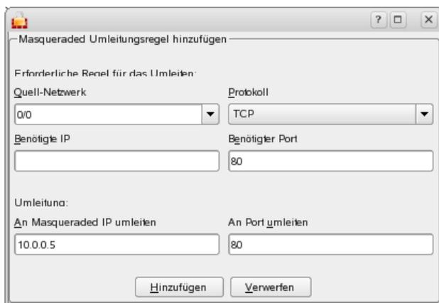
Abbildung 14.7: Auch ein Port- oder IP-Forwarding kann leicht eingerichtet werden.
