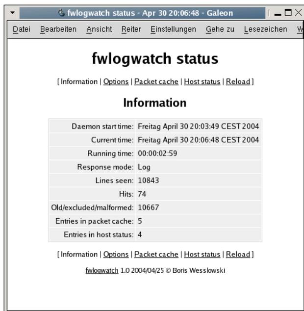
Abbildung 12.2: Im Echtzeitmodus kann Fwlogwatch seinen Status über ein Web-Interface anzeigen.
