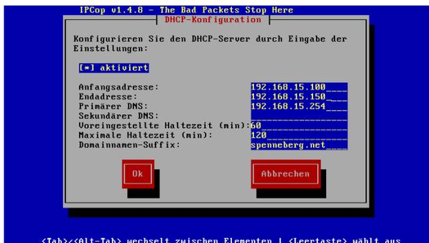
Abbildung 14.17: IPCop kann selbst als DHCP-Server für das grüne Netz arbeiten.
