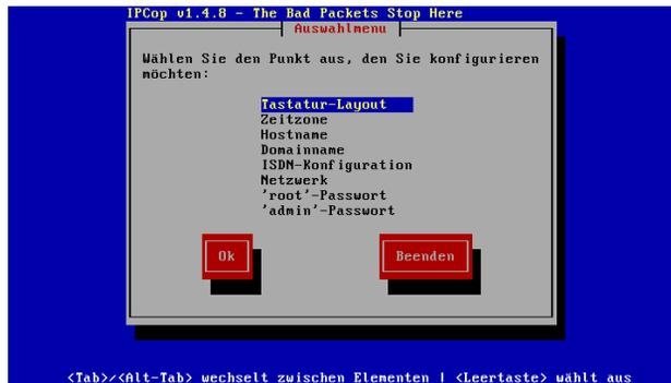
Abbildung 14.19: Ein Aufruf der Konfigurationswerkzeuge ist auf der Konsole mit dem Befehl `setup` möglich.
